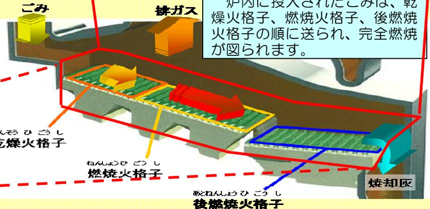
炉内に投入されたごみは、乾燥火格子、燃焼火格子、後燃焼火格子の順に送られ、完全燃焼が図られます。
